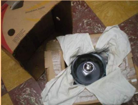
La MN « carton à bananes » a été fabriquée lors d'un atelier. Un carton à bananes en extérieur, un carton aux dimensions de la casserole en intérieur, entre les 2 l'isolation est faite en papier journal roulé en boulettes qui sont ensuite bien tassées. Le couvercle du carton à bananes contient aussi une couche de boulettes de papier journal.
