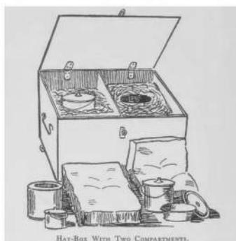
Hay-box auto-construite à deux compartiments remplis de foin. Un cylindre-séparateur est prévu pour y placer un petit récipient, les grandes marmites vont directement dans le foin. Le tout est recouvert par un coussin<sup>2</sup>.
